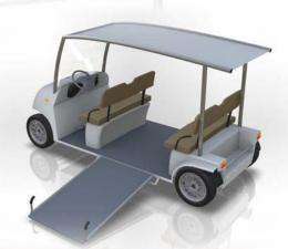
Серия легких медицинских электромобилей класса гольфкар, предназначенная для перевозки больных, в том числе лежачих (на носилках) и на колясках, по территориям лечебных и оздоровительных учреждений, из корпуса в корпус, а также для развоза пищи из пищеблока и оборудования. Могут быть оборудованы проблесковыми маячками, цветографической схемой с красным крестом, местом и универсальным креплением для носилок, пространством для колясочных пациентов, выдвижным пандусом, грузовым отсеком.
